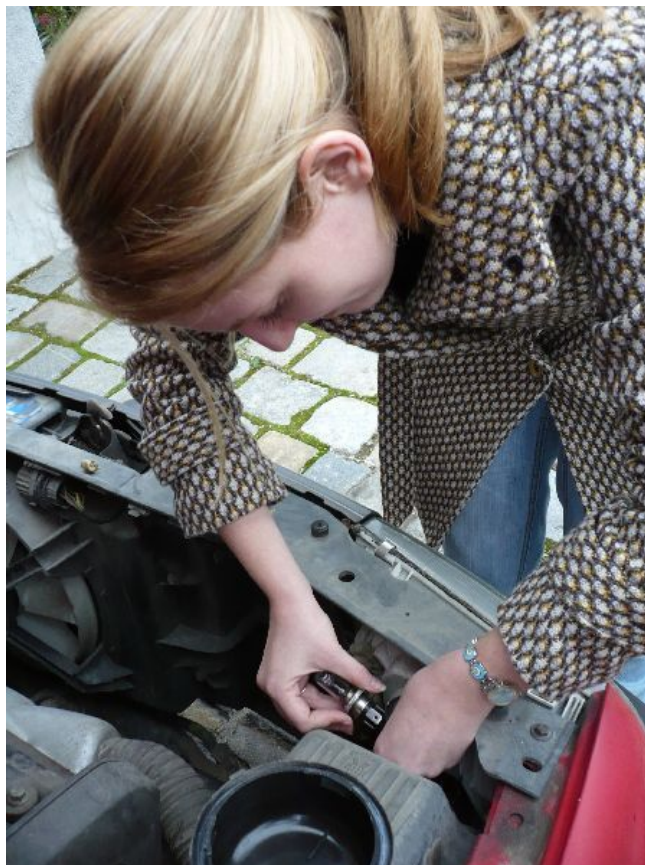
4. image005: alte Lampe rausziehen / neue Lampe reinstecken
