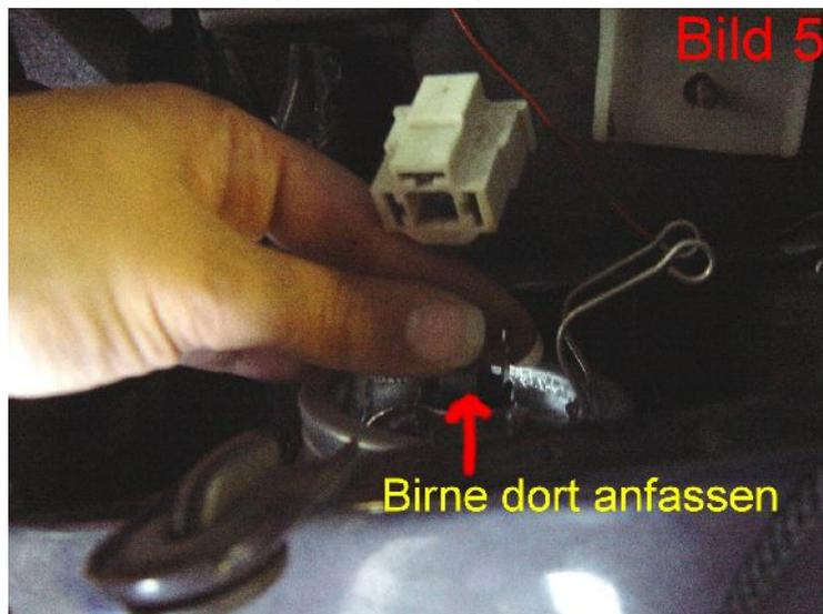
6 Schritt: Setzen Sie die neue Birne ein (so einsetzen das der Stecker hinterher auch wieder richtig befestigt werden kann "auf Schlitzte achten")
