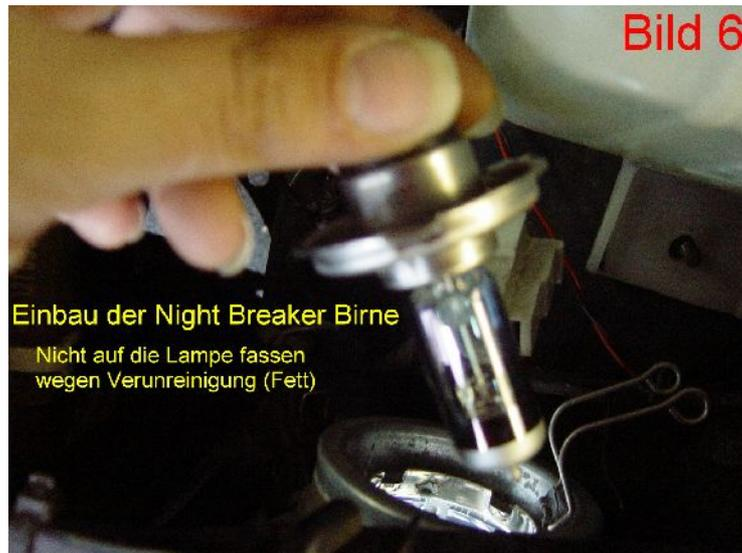
7 Schritt: Befestigen Sie die Birne wieder mit der Spangenhalterung (sh. Bild 3)
