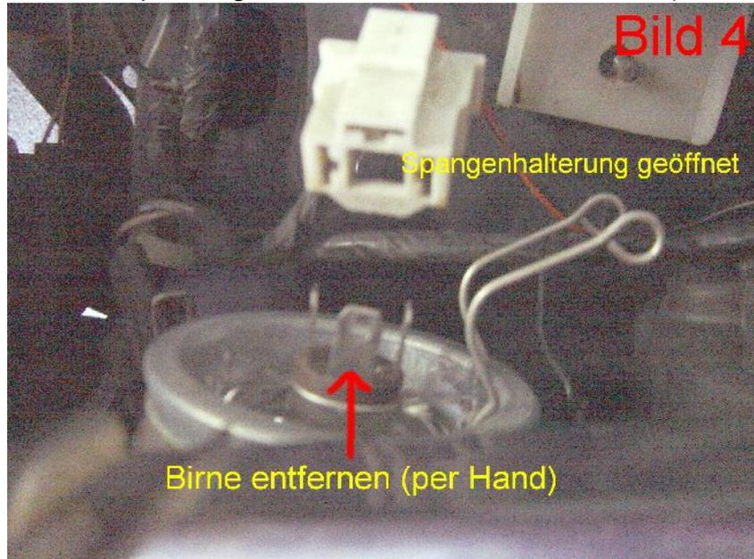
5 Schritt: Holen Sie die "neuen" Glühbirnen aus der Verpackung !ACHTUNG! Fassen sie nicht mit Ihren Fingern auf die Lampe sondern unten am Ende damit diese nicht verunreinigt werden (Fettrückstände)(sh. Bild 4.1)
