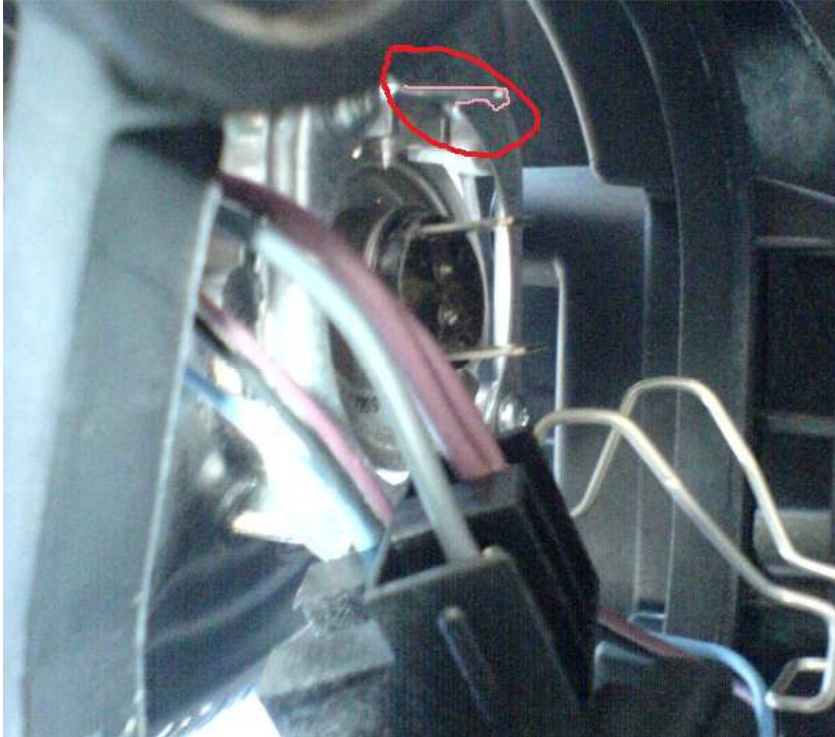
Abbildung 4: Haken (hervorgehoben), der den Bügel (rechts unten) festhält
