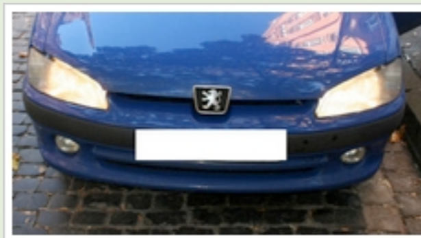
Scheinwerfer rechts neu, links alt:
