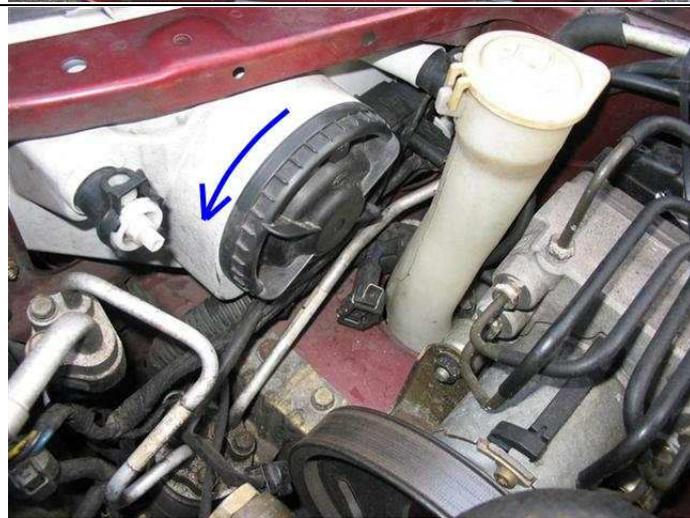
Um an die Lampe zu gelangen muss die schwarze Abdeckung durch eine leichte Drehung gelöst und dann abgenommen werden.
