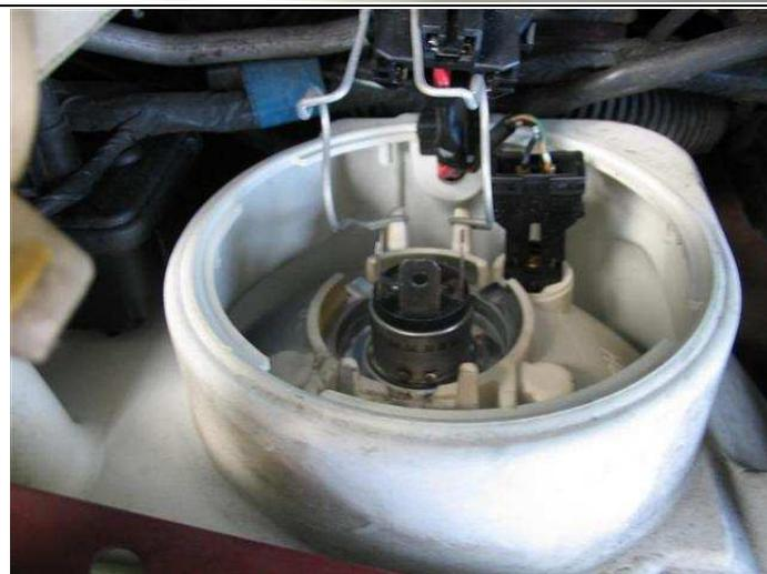
Nach Herunterklappen der Halteklammer liegt die Lampe lose im Reflektor.
