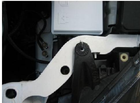
2. Klipps an der Unterseite des Scheinwerfers mit Hilfe des langen Schraubenziehers lösen (1 Klipp rechts und 1 Klipp links am Scheinwerfer s. Bild)
