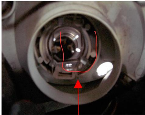
Diesen Ring klappt man nach oben hoch und kann dann die Lampe herausziehen und die neue Birne einsetzen.
