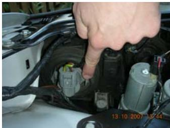
Rückansicht des rechten Scheinwerfers. Ca. 2 cm links ist das ‚Plastikteil‘ wo der Finger draufzeigt noch mal. Einfach mit Daumen und Zeigefinger beide Plastikteile drehen und schwups kommt die Glühbirne zum Vorscheinen!
